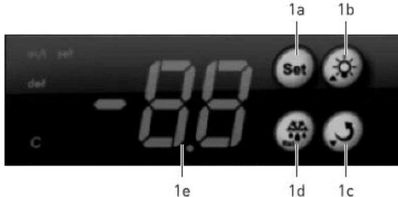
**1a. Bouton de réglage de la température, maintenir appuyé 3 à 4 secondes jusqu'à ce que l'indication « St » apparaissent pour entrer dans le mode de réglage. Appuyer de nouveau sur le bouton pour régler la température de l'appareil. Après 30 secondes d'inaction, la nouvelle température réglée est automatiquement enregistrée.**
